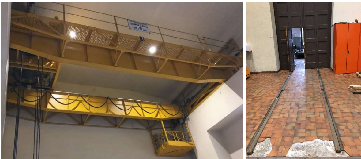
Figura 14: Carro ponte 70 ton presente nella centrale Piottino (destra) e binari di servizio dell'officina (sinistra).
